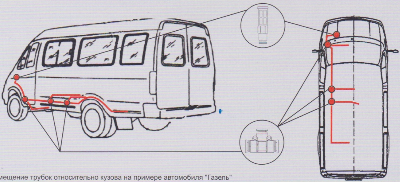
КПП Трубка: 0,8 м. Болт-Штуцер: M10x22x1
